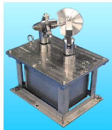
写真 1 正弦波動生成型攪拌機
