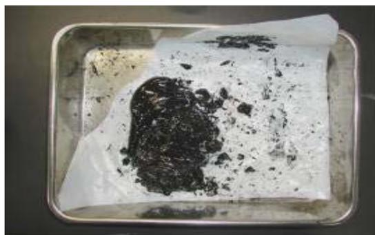
図2 室温下での石油アスファルト外観
