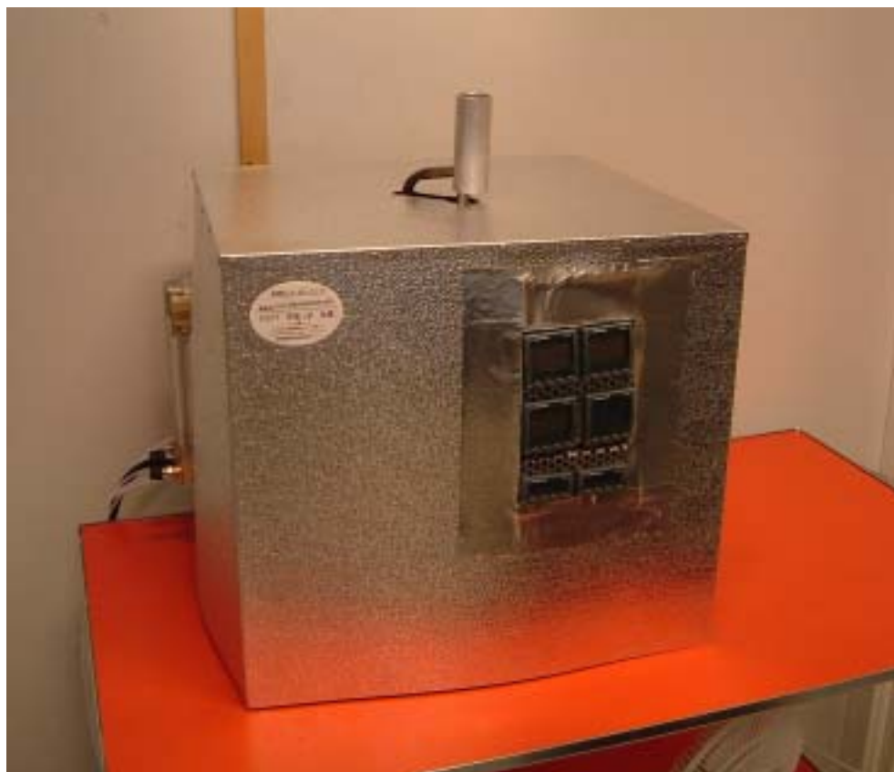
図 2 . 2 - 2 1 kW級灯油水素製造装置概観写真
