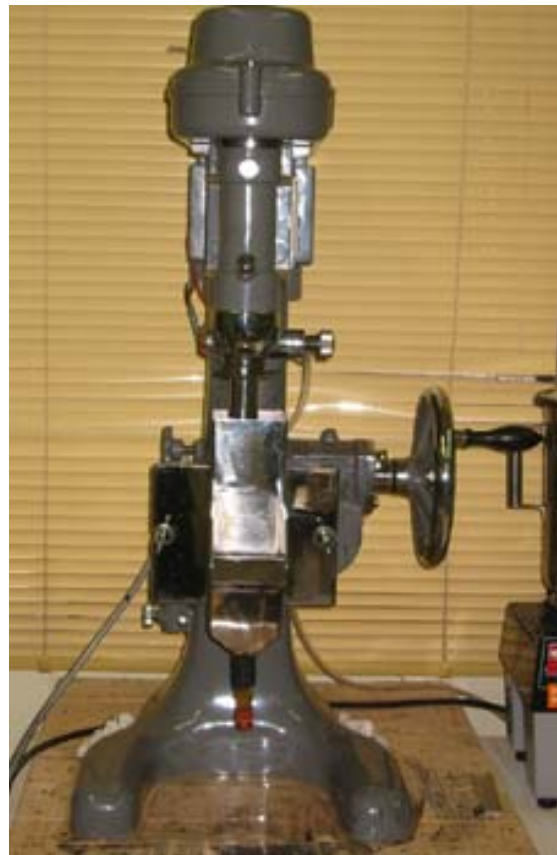
図2.5 機械式浮遊選鉱実験装置
