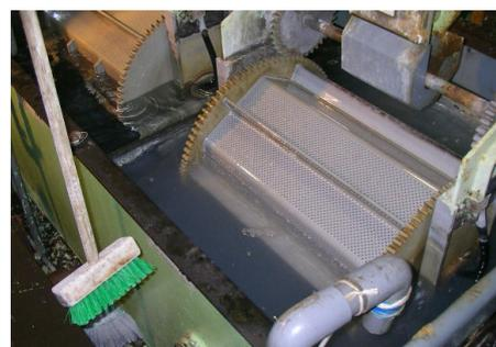
デッキブラシ洗浄を行うバッチ式水洗槽
