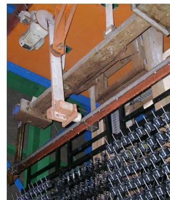
めっき自動化ラインでの液切りの工夫(ハンマーで叩いて液切り)
