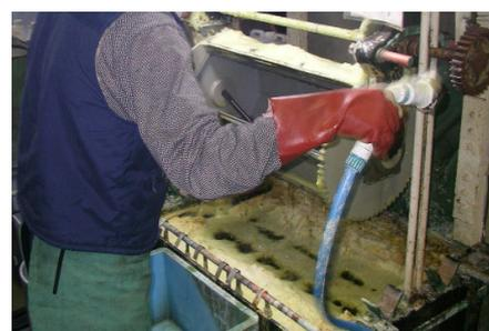
作業場所から移動せず手の届く場所にシャワーを設置して負担を軽減
